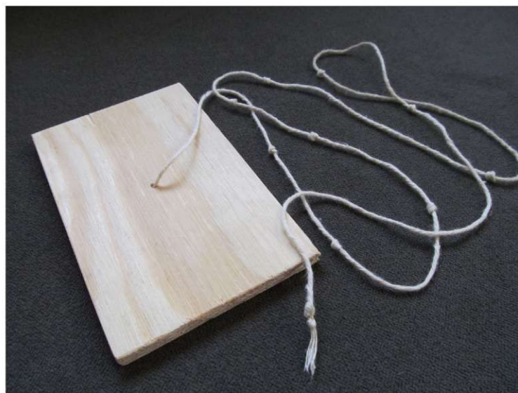
Un simple kamal que se puede hacer hoy en día. Las versiones más antiguas podían ser de madera de caoba fina con tallas intrincadas. Por Bordwall, CC BY-SA 30.
