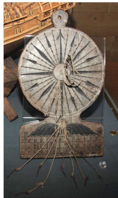
Una tabla de navegación que se utilizaba para seguir la velocidad y la dirección de un barco durante cuatro horas continuas.
