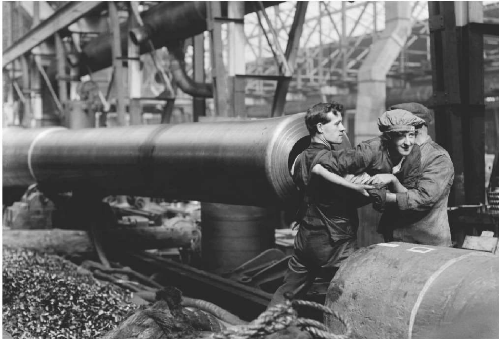
“Una trabajadora de municiones es levantada en el cañón de un arma naval de 15 pulgadas para limpiar el estriado”. Fotografía tomada por Horace Nicholls. Por Imperial War Museums, dominio público.
